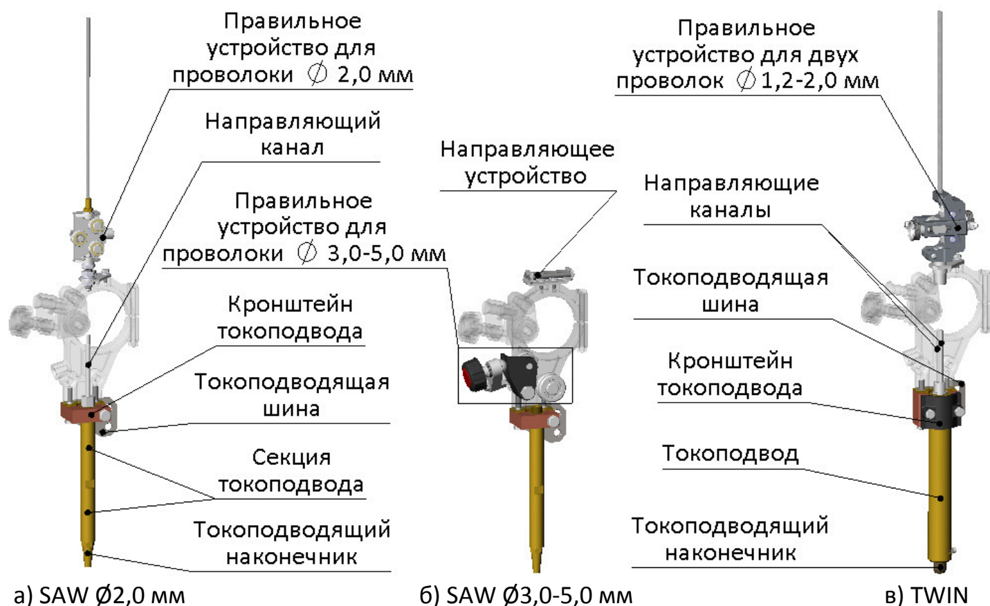
Рис. 4.8. Токоподводы для сварки SAW и TWIN.
