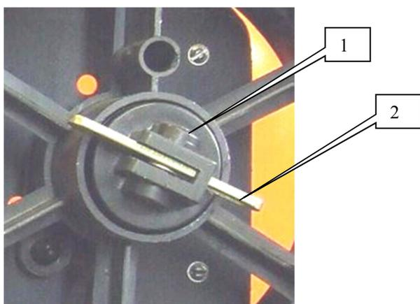
**Внимание!** Тормозной момент для электродных проволок разных диаметров и разных марок будет различным, что определяется упругостью самой проволоки.
