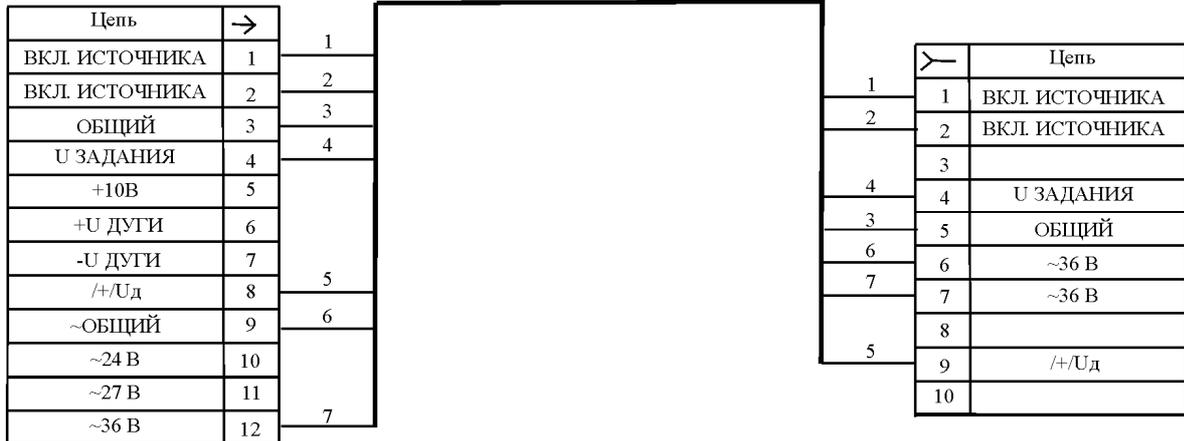
Схема соединительного кабеля №2
